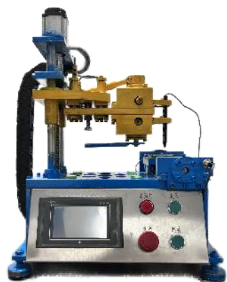
金属探伤仪校准装置
