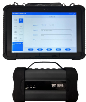
OBD诊断仪标准试验装置
